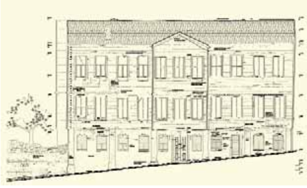
Şekil 28. Kuzeydoğu Cephesi Rölöve Çizimi
